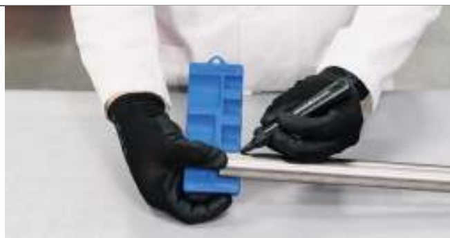
Рис. 28. Маркировка глубины вставки.
